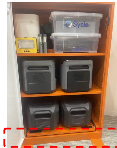
この隙間(BOX脚裏)に 転倒防止用のおもりを入れております。
